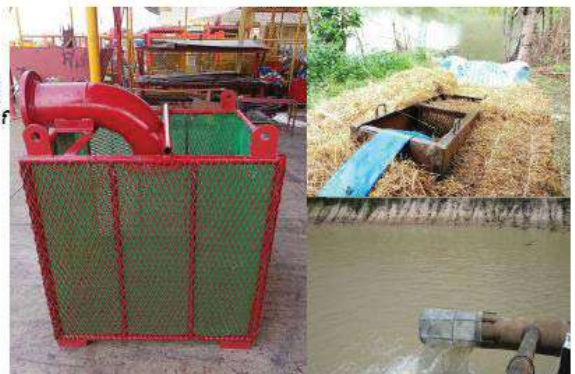
ระบายน้ำลงถัง/บ่อพักน้ำ (Splash Box/Pond) เพื่อช่วยลดความดันน้ำ และป้องกันการกัดเซาะตลิ่ง
