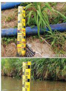
ติดตั้งไม้วัดระดับน้ำ (Staff Gauge) บริเวณจุดสูบน้ำและระบายน้ำ
